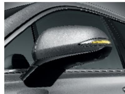
Répétiteurs latéraux à LED intégrés aux rétroviseurs extérieurs.
